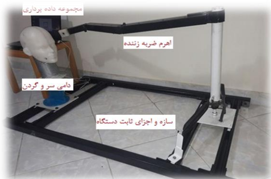
شکل ۱. دستگاه آزمایش (متشکل از یک دامی سر و گردن، اهرم ضربه زننده، سازه و اجزای ثابت و مجموعه داده‌برداری)
