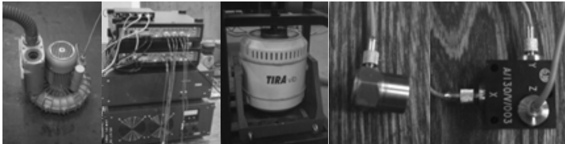
شکل (۳). قسمت‌های مختلف دستگاه اندازه‌گیری ارتعاش و ثبت آن. به ترتیب از راست به چپ: (شتاب سنج سه جهتی، شتاب سنج یک جهتی، دستگاه لرزاننده، تقویت کننده و کمپرسور هوا)
