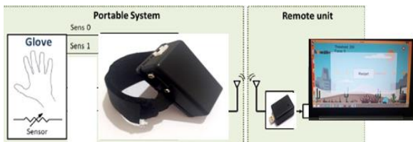
شکل ۲. سیستم طراحی شده برای انجام تمرینات ایزومتریک گردن در گروه تمرین با بازی
