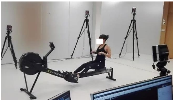
شکل ۱. وضعیت آزمودنی روی دستگاه ارگومتر به همراه دوربین‌های ثبت حرکت و نشانگرها
