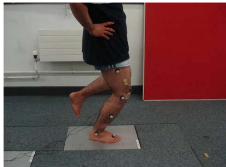
شکل ۱. اندازه‌گیری مختصات حرکتی و نیروهای وارده بر زانو حین اجرای حرکت چمباتمه زدن بر روی یک پا
