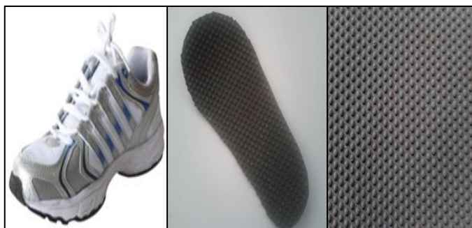
شکل ۱. بافت، کفی بافت‌دار و کفش مورد استفاده در مطالعه حاضر (بافت از جنس اتیل ونیل استات با ضخامت یک میلی‌متر و دارای برجستگی‌های نیم‌دایره‌های به ارتفاع یک میلی‌متر، قطر ۲ میلی‌متر و فاصله‌ی مرکز تا مرکز ۴ میلی‌متر)
