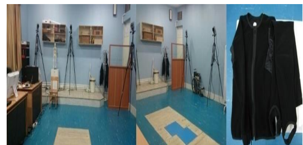
شکل ۱. نحوه قرارگیری دوربین‌ها در اطراف مسیر راه رفتن و لباس‌های مخصوص برای قراردادن مارکرها روی لندهمارک‌های استخوانی
