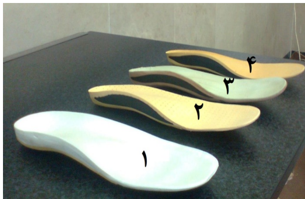
شکل ۱. تصویری از ۴ نوع مختلف کفی به کار برده شده در این پژوهش. شماره ۱: کفی معمولی، شماره ۲: کفی نرم، شماره ۳: کفی نیمه سخت، شماره ۴: کفی سخت.
