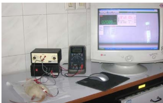
شکل ۱. Set up اندازه‌گیری پتانسیل تفاضلی پوست
