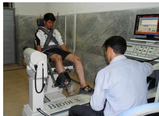
شکل ۱. اجرای آزمون ایزومتریک با دستگاه بایودکس
