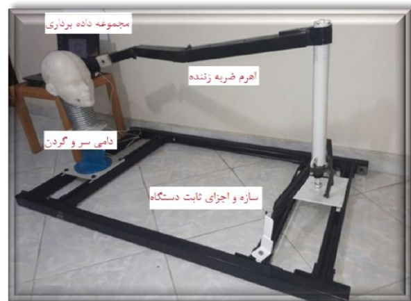
شکل ۲. دستگاه آزمایش (متشکل از یک دامی سر و گردن، اهرم ضربه زننده و تجهیزات داده‌برداری)
