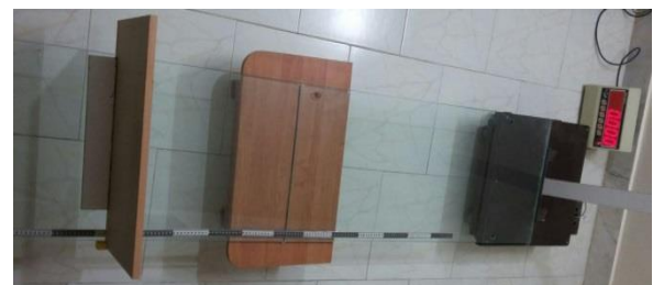
شکل ۱. ابزارهای آماده شده برای محاسبات اندازه‌گیری مکان مرکز جرم به روش تخته توزین
