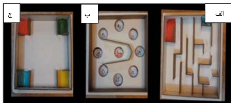
شکل ۲. بازی‌های مورد استفاده در دستگاه شامل بازی ماز (الف)، چاله‌های امتیازی (ب) و تفکیک توپ‌های رنگی (ج)
