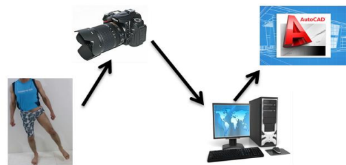
شکل ۳. نمای شماتیک اندازه‌گیری زاویه مفصل با سیستم متشکل از فوتوگرافی دیجیتال نشانگرهای غیر منعکس‌کننده و آنالیز با نرم‌افزار AutoCAD
