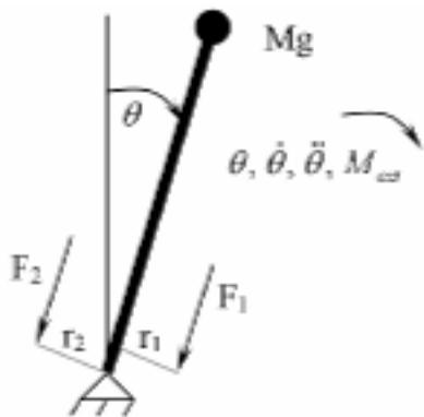
شکل ۱. شماتیک یک پاندول معکوس به عنوان یک مدل یک درجه آزادی از تنه یا بازو.
