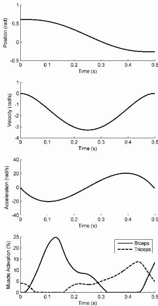
شکل ۳. منحنی های سینماتیک حرکت آرنج در فلکشن بازو از  $55^{\circ}$  فلکشن به  $105^{\circ}$  فلکشن در مدت ۰/۵ ثانیه، و فعالیت عضلات دو سر و سه سر (زاویه بر حسب توضیح شکل ۱).
